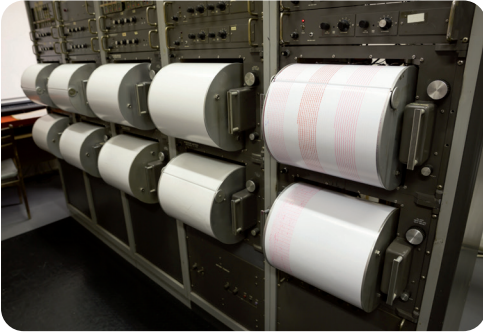
Un sismógrafo detecta el movimiento de la corteza de la Tierra cuando pasan las ondas sísmicas
