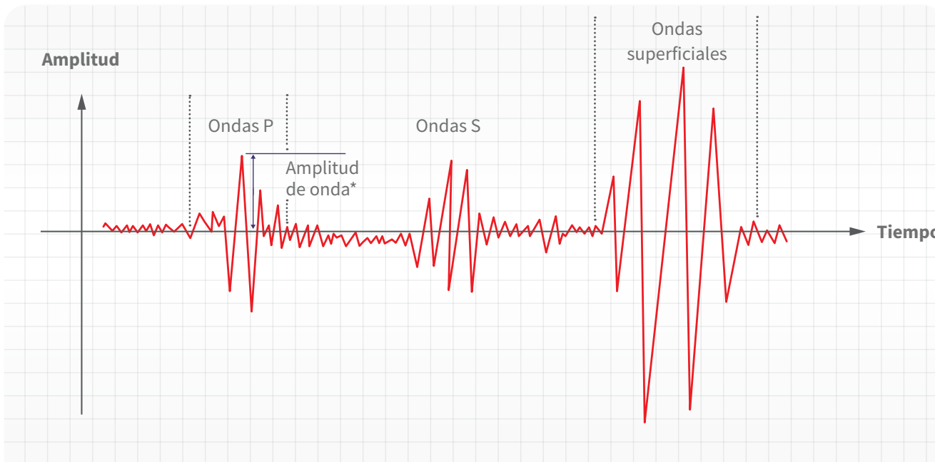
Un sismógrafo detecta el movimiento de la corteza de la Tierra cuando pasan las ondas sísmicas
